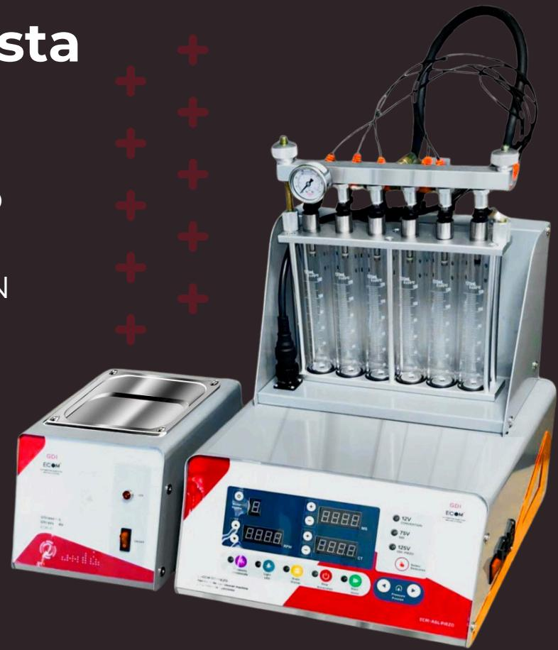
✓ Prueba Inyectores PiezoElectricos Alto Voltaje, GDI Magneticos, EFI, MPI, Side Feed y otros.
